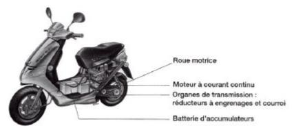
Un scooter est piloté par un conducteur qui au moyen d'une poignée peut modifier la vitesse de déplacement du scooter. La poignée envoi en fait une information à un microcontrôleur qui va gérer un modulateur d'énergie (hacheur) qui alimentera un moteur à courant continu, sous une tension moyenne variable.
